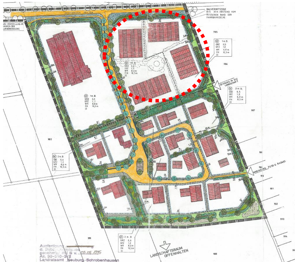
Abb. 4: Auszug aus dem Bebauungsplan mit integriertem Grünordnungsplan „Gewerbegebiet Weichering“ der Gemeinde Weichering (i.d.F. von 19.05.1995) mit Kennzeichnung des Teiländerungsbereiches, ohne Maßstab
