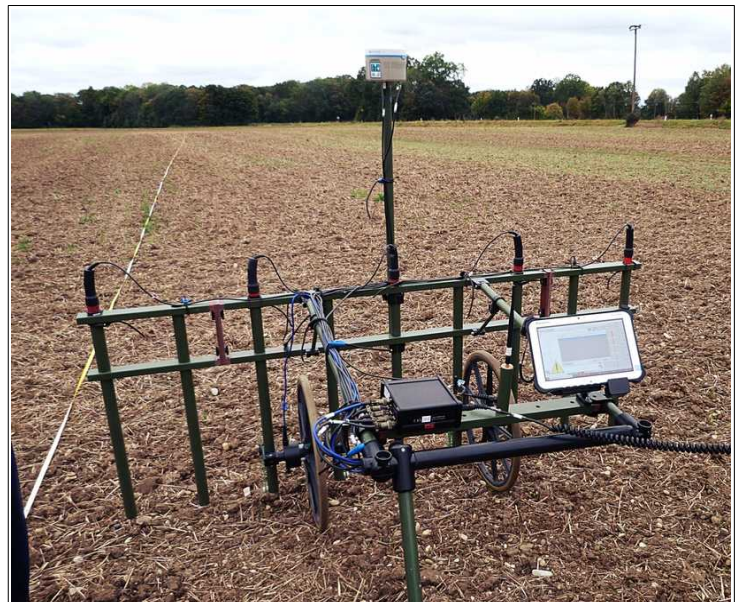
Abbildung 3: Das Gradiometer „MXPDA“ (Firma Sensys), ein Geschobener Sondenträger mit 5 Kanälen und GPS-Empfänger.
